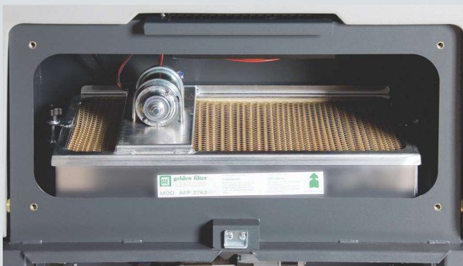
Układ automatycznego czyszczenia filtra - co 5 minut.
