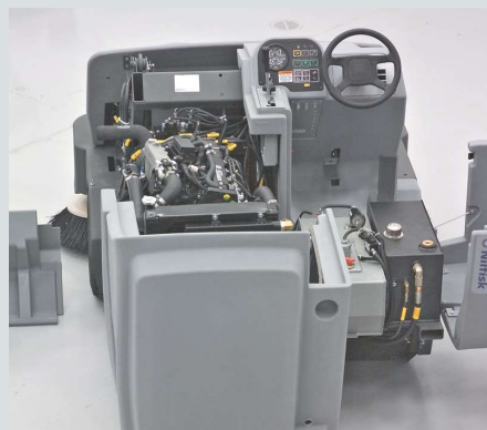
System NoTools™ firmy Nilfisk czyni obsługę niezwykle prostą. 5-stronny dostęp do silnika i elementów hydraulicznych pozwala zaoszczędzić cenny czas, a także zredukować koszty pracy
